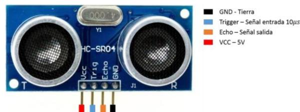
**Figura 3:** Sensor ultrasonido HC-SR04.
