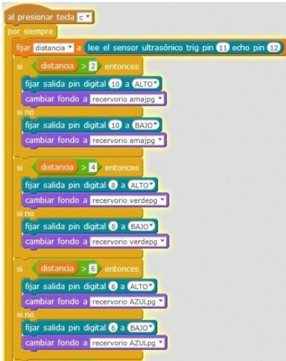
**Figura 7:** Bloque de adquisición de datos del sensor ultrasonido.
