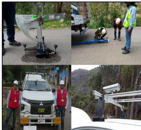
Ensayos técnicos de ingeniería realizados en campo: péndulo británico, deflectometría con viga Benkelman y perfilómetro láser en el pavimento flexible
